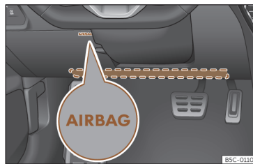
Fig. 36 En el lado del conductor: ubicación del airbag para las rodillas.
