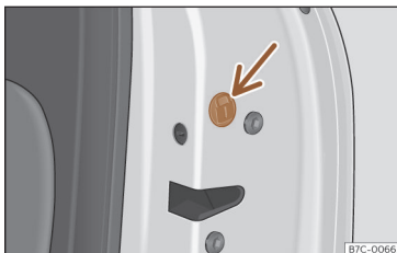
Fig. 73 Bloqueo de emergencia de la puerta.
