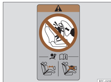
Fig. 40 Adhesivo del airbag: en el marco posterior de la puerta del acompañante.
