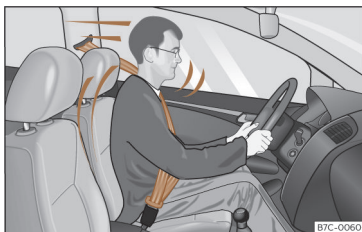
Fig. 19 Los conductores que lleven el cinturón de seguridad correctamente abrochado no saldrán lanzados en caso de un frenazo brusco.
