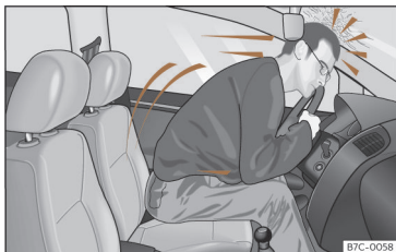
Fig. 21 El conductor que no lleve puesto el cinturón de seguridad se verá proyectado hacia adelante.
