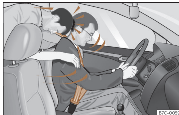
Fig. 22 El ocupante del asiento trasero que no lleve puesto el cinturón de seguridad se verá proyectado hacia adelante sobre el conductor que sí lleva el cinturón.
