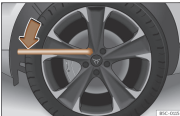
Fig. 234 Cambio de rueda: aflojar los tornillos de rueda.
