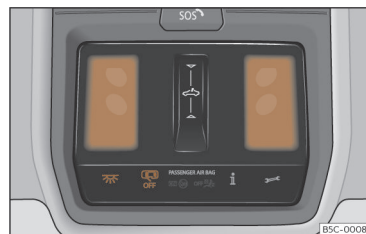
Fig. 101 Detalle del revestimiento del techo: iluminación delantera del habitáculo.
