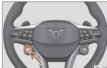
Fig. 117 Volante multifunción: botón para cambiar el perfil de conducción.
