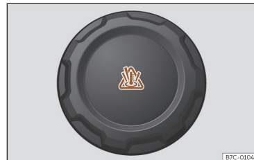
Fig. 217 Vano delantero: tapón del depósito de expansión del líquido refrigerante.
