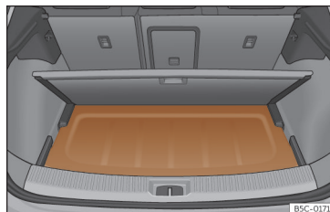
Fig. 174 En el maletero: colocación de la bandeja.
