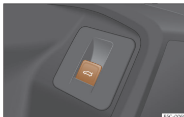
Fig. 77 En la puerta del conductor: tecla para abrir y cerrar el portón trasero.
