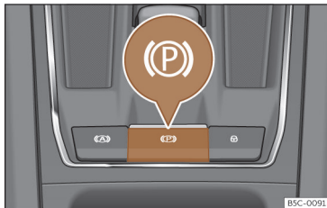
Fig. 145 En la parte inferior de la consola central: tecla del freno de estacionamiento electrónico.
