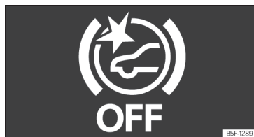
Fig. 136 En la pantalla del cuadro de instrumentos: indicación de Front Assist desactivado.
