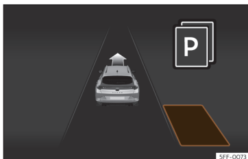
Fig. 149 En la pantalla del cuadro de instrumentos: visualización del sistema de aparcamiento asistido con visualización reducida.
