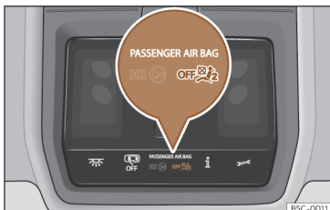
Fig. 30 En la consola del techo: testigo de control de la desactivación del airbag del acompañante.
