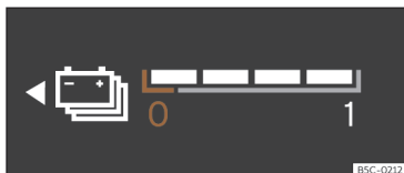
Fig. 5 Cuadro de instrumentos digital: indicador del nivel de batería.
