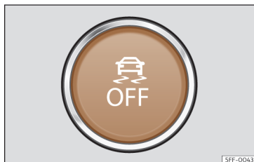
Fig. 118 En la parte inferior de la consola central: botón para conectar/desconectar el ESC
