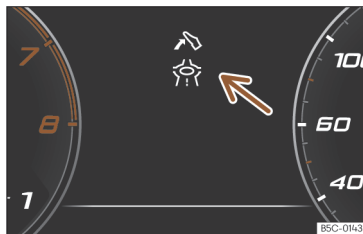
Fig. 10 Indicación de la asistencia para una conducción ecoeficiente (representación esquemática).
