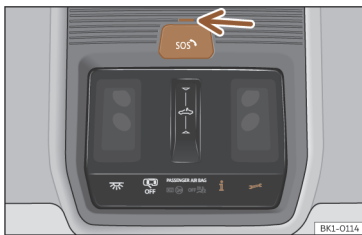
Fig. 50 En la consola del techo: mandos para los servicios de voz.
