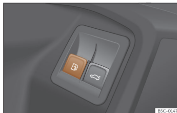
Fig. 200 Puerta del conductor: desbloqueo de la tapa del depósito.
