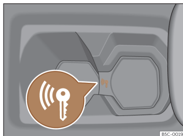
Fig. 112 En la consola central: arranque de emergencia.
