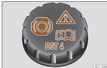
Fig. 218 Vano motor: tapón del depósito del líquido de frenos.
