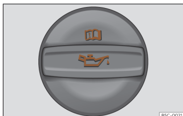
Fig. 223 Tapa de la boca de llenado de aceite del motor en el vano motor.
