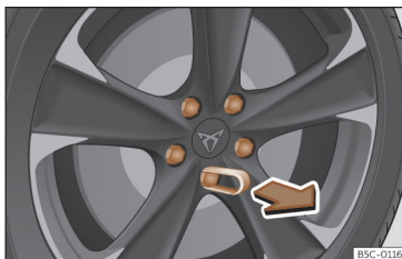
Fig. 232 Rueda: tornillos de la rueda con capuchones.
