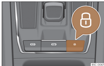
Fig. 71 En consola central: conmutador del cierre centralizado
