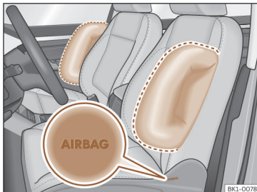
Fig. 33 Airbag lateral en el asiento del conductor y del acompañante.
